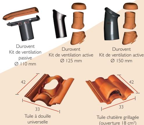
**A noter : pour une meilleure efficacité, les tuiles à douille doivent être placées au plus près du faîtage.**
