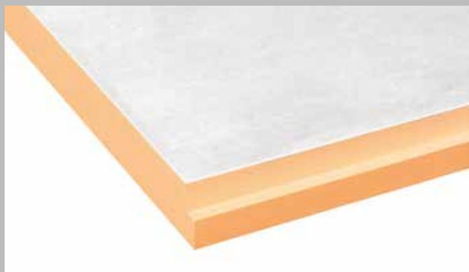
**SOPRA XPS Protect Artic C** est un complexe associant un panneau isolant XPS à un enduit ciment de parement de 3 mm. Dans le cas d'une toiture-terrasse inversée, les panneaux **SOPRA XPS Protect Artic C** sont mis en œuvre sur l'étanchéité du relevé. Ils sont ensuite maintenus en tête avec des pattes de fixation.
